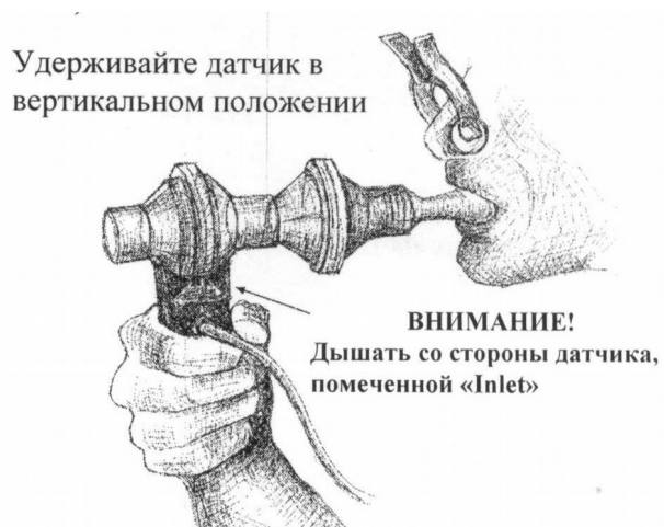
Рис.10. Схема положения датчика для процедуры калибровки.
